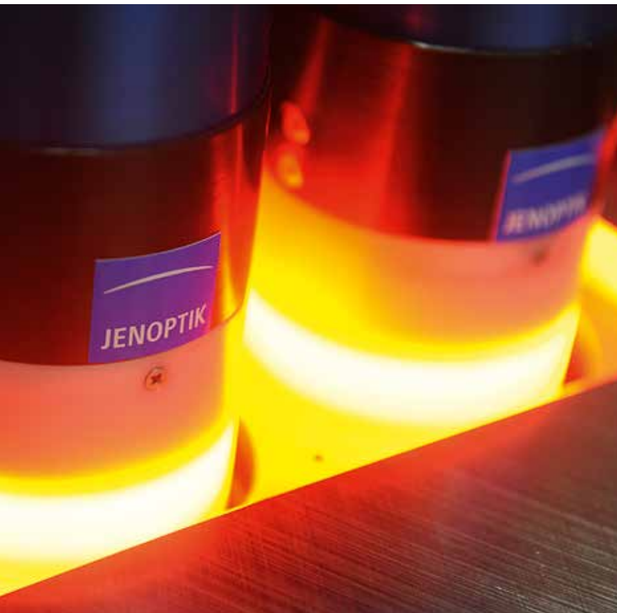
Die automatische Rundum-Inspektion von Zylinderbohrungen garantiert den Kunden hohe Präzision in der Motorenfertigung.
