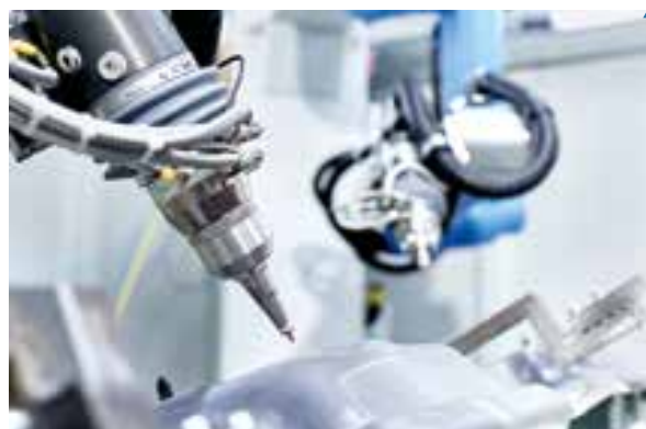
Roboterbasierte Laseranlagen zum Schneiden und Schweißen von Metall.
