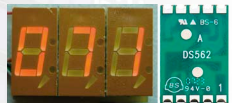
Bild 4: LED-7-Segment-Bauelement mit Lichtschacht (hybrid einstellig und mehrstellig zusammengesetzt)
